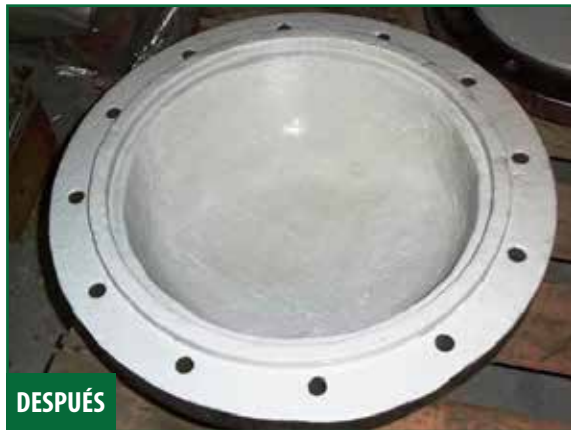
Cabezal flotante del intercambiador de calor antes y después de rellenar los hoyos en acero con Novocoat EP3900 Machinable Paste . Novocoat SC5400 Tank Lining aplicado como capa superior.
