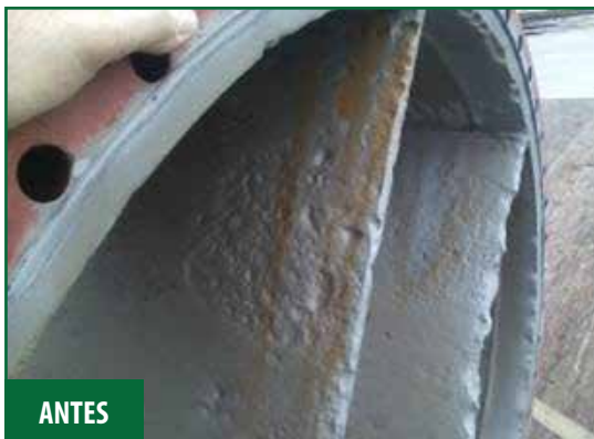
Acero piteado y desgastado reconstruido con Novocoat EP3900 Machinable Paste .
